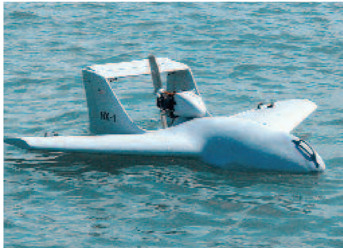
Sopra, l’UAS RQ-15 Neptune di DRS che è completamente impermeabile e può essere utilizzato sia su piattaforme terrestri sia acquatiche. Nella pagina accanto, un UAV Predator
